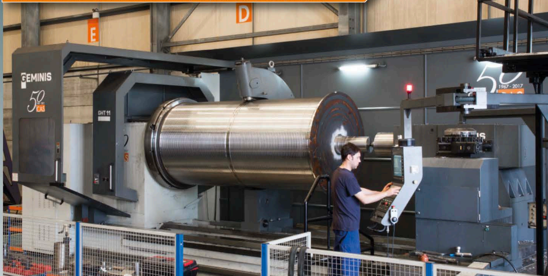
Torno Geminis GHT11 Ø3.000x10.000, 5 torretas independientes: torneado, mandrinado interior, rectificado ext., rectificado int., fresado. Lathe Geminis GHT11 Ø3.000x10.000, 5 separate accessories: turning, boring, internal grinding, external grinding, milling.
